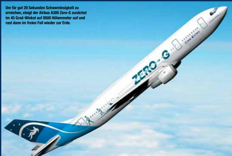
Genau 22 Sekunden Schwerelosigkeit herrschen im Inneren des Airbus A300 Zero-G, dem größten fliegenden Labor der Welt, wenn es hoch über dem Atlantik in den Sinkflug geht. In diesen 22 Sekunden können Wissenschaftler Experimente durchführen und zum Beispiel neue Werkstoffe für den Flugzeugbau und die Raumfahrt testen. Fabian Zimmer, Maschinenbaustudent an der Friedrich-Alexander-Universität Erlangen-Nürnberg (FAU), war bei einer dieser Parabelflugmissionen dabei.
