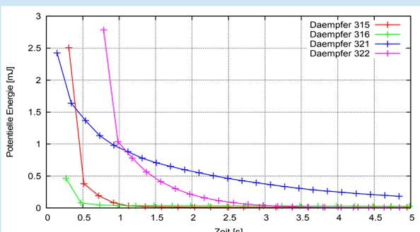
Vergleich der potentiellen Energie verschiedener Dämpfer in Abhängigkeit von der Zeit
