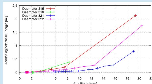
Bei gleicher Schwingungsamplitude dämpft ein Dämpfer mit mehr Granulat stärker
